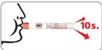
Fare un respiro profondo e soffiare nel boccaglio in conformità con le frecce sull'etilometro. L'aria deve essere espirata due volte per circa 10 secondi. Non interrompere il ciclo di espirazione. Assicurarsi che l'aria sta uscendo dall'altra parte dell'etilometro
