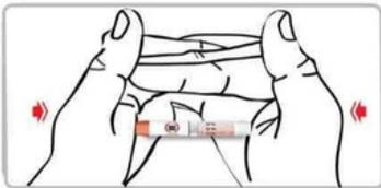
Rompere la pellicola protettiva premendo tappi di protezione su entrambi i lati dell'etilometro fino alla rottura della pellicola di protezione
